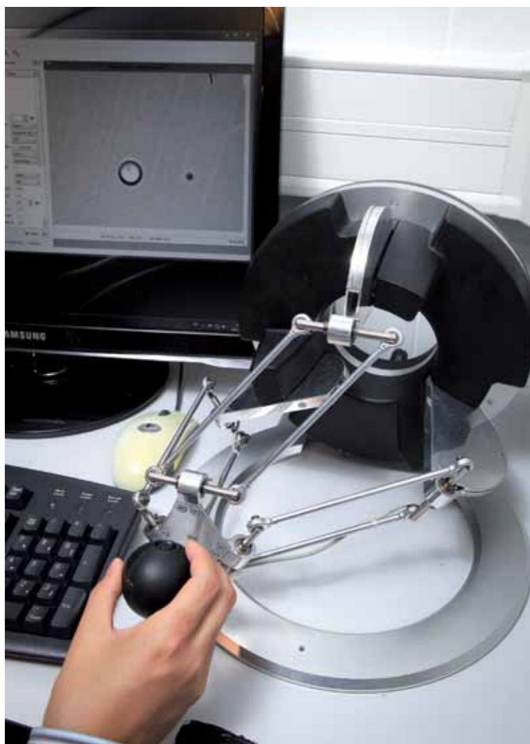
Un micromanipulateur avec retour haptique a été mis au point à l'université Pierre et Marie Curie (Paris).
